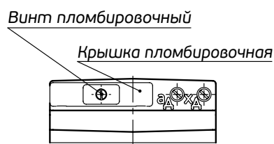
Рис. 2 - Общий вид трансформатора ЗНОЛ-СВЭЛ-0,66 с двумя вторичными обмотками (с дополнительной вторичной обмоткой)
