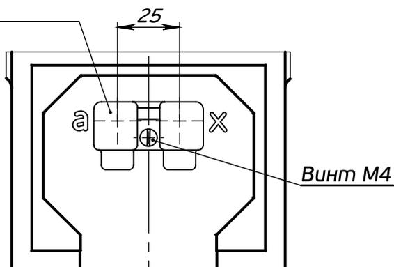
Рис. 2 - Панель контактов трансформаторов
