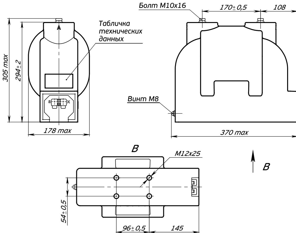
Рис. 1 - Общий вид трансформаторов напряжения НОЛ-СВЭЛ-6(10)М
