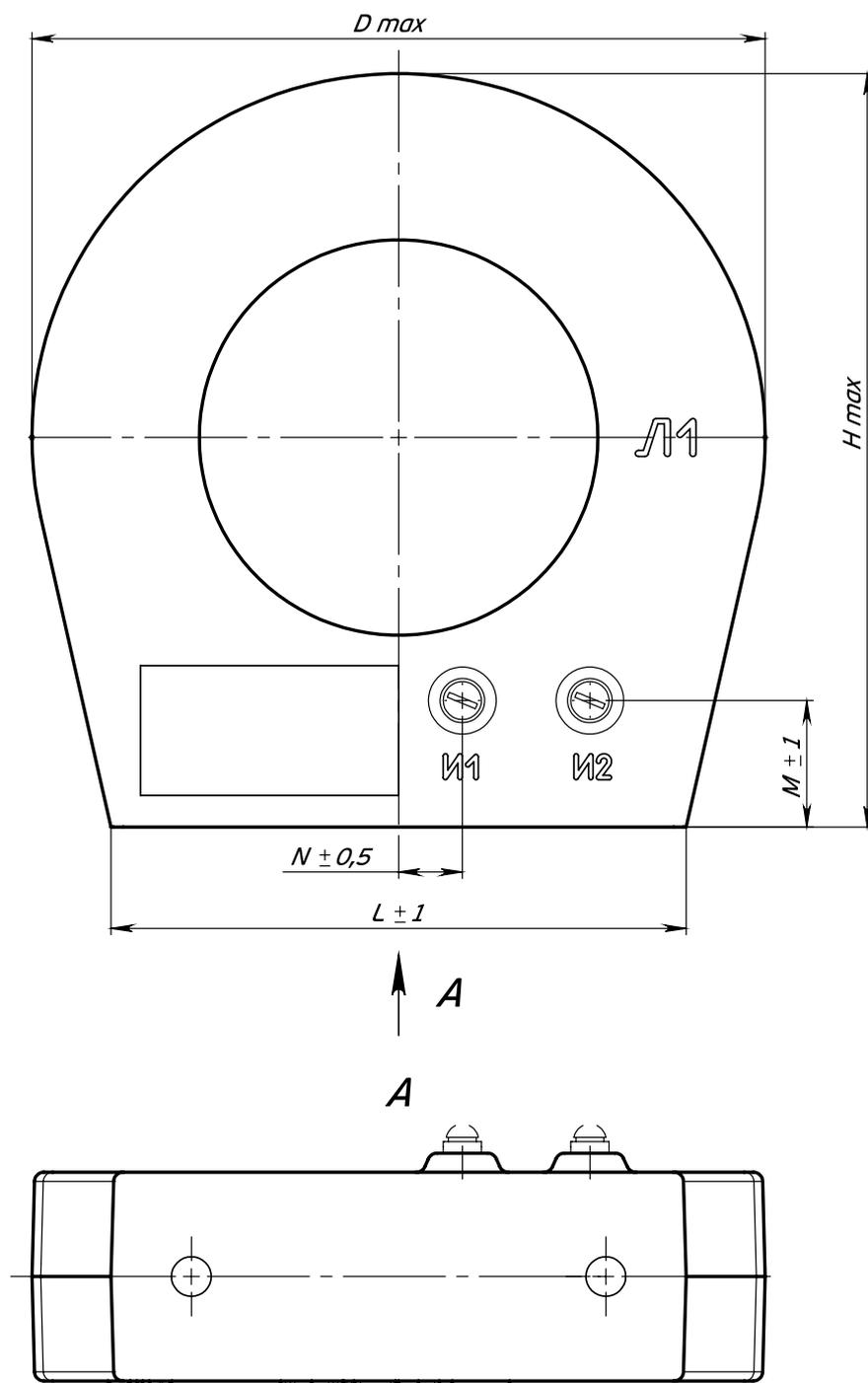
Рис. 2 - Общий вид трансформаторов тока ТЗЛК-СВЭЛ-0,66-125(200).
