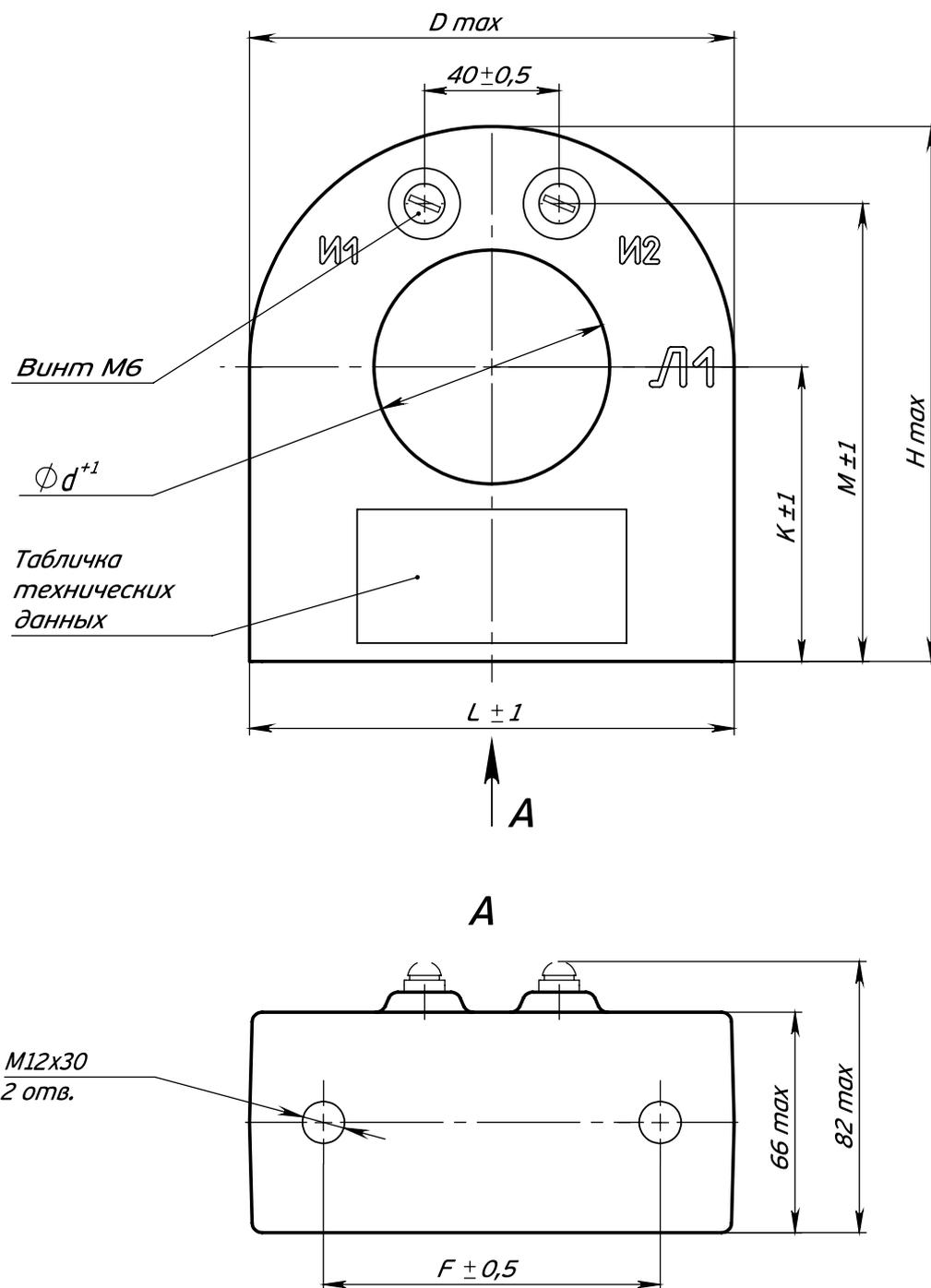
Рис. 1 - Общий вид трансформаторов тока ТЗЛК-СВЭЛ-0,66-70(100)
