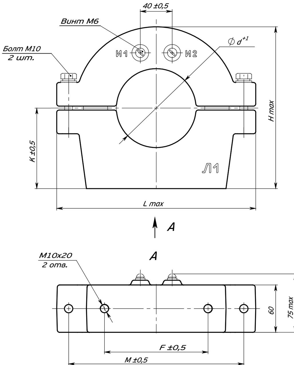
Рис. 1 - Общий вид трансформаторов тока ТЗЛКР-СВЭЛ-0,66.
