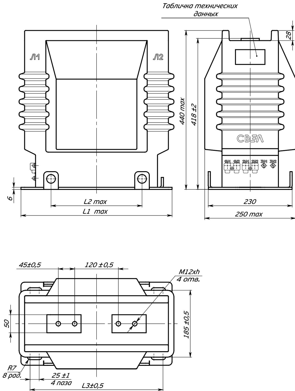
Рис. 1 - Общий вид трансформатора тока ТОЛ-СВЭЛ-35 УХЛ 2
