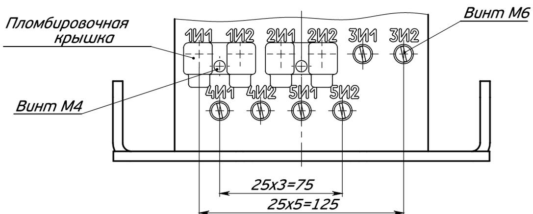
Рис. 3 - Панель контактов трансформатора тока ТОЛ-СВЭЛ-35 УХЛ 2
