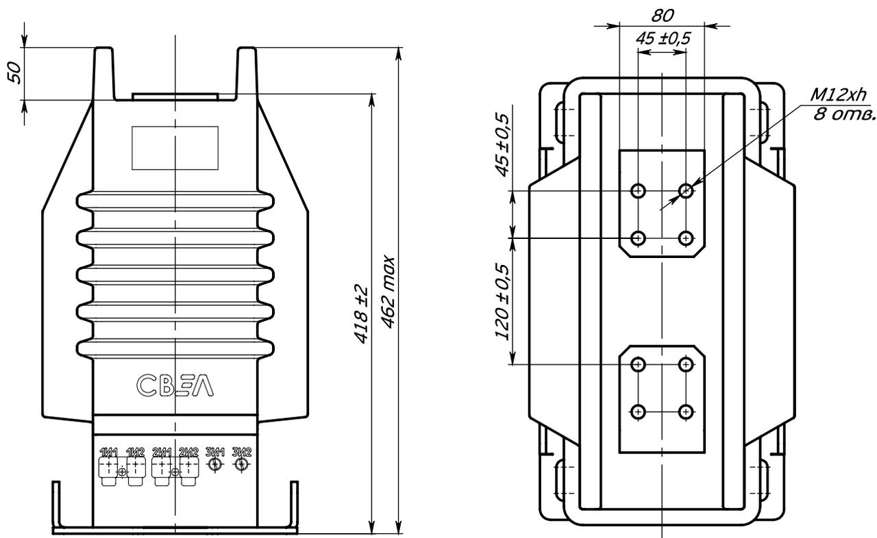
Рис. 2 - Общий вид трансформатора тока ТОЛ-СВЭЛ-35 УХЛ 2 на номинальные первичные токи 2500, 3000 А
