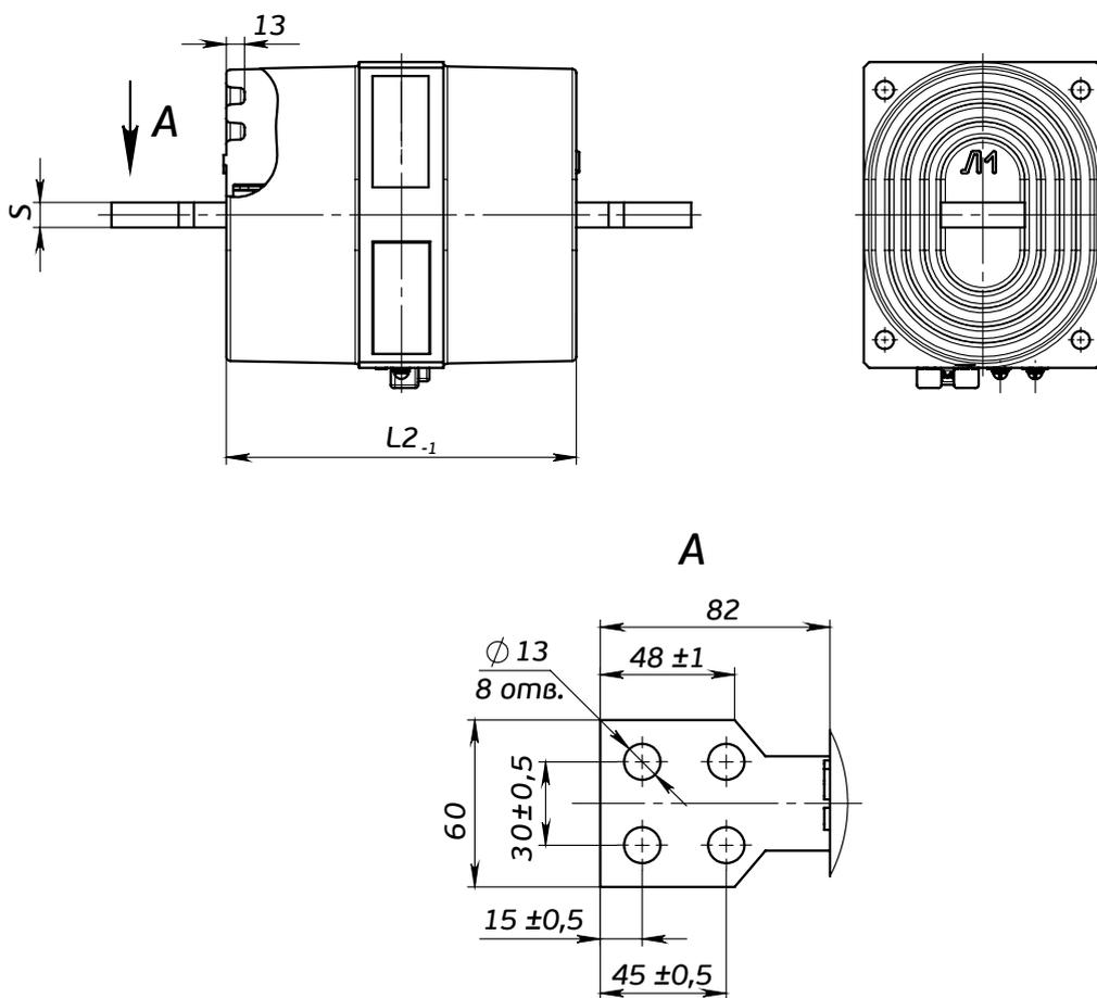
Рис. 4 - Общий вид трансформатора ТПОЛ-СВЭЛ-10М
